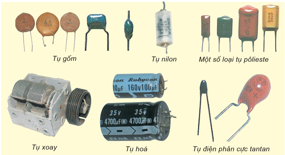
Hình 2 – 3. Hình dạng một số loại tụ điện
